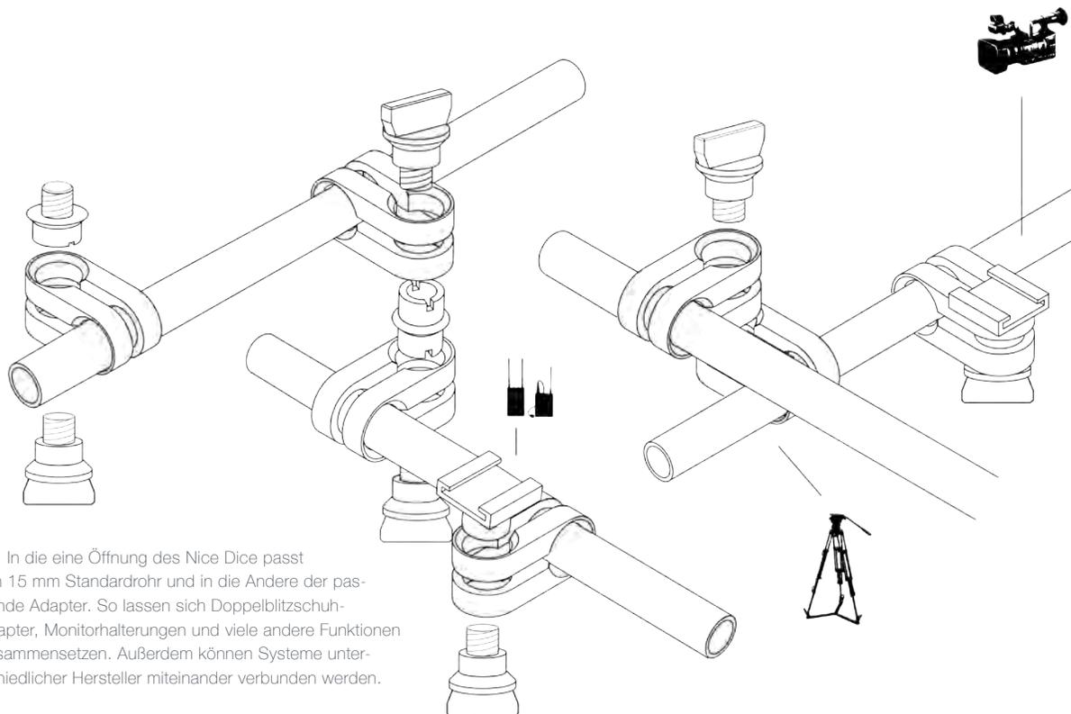
In die eine Öffnung des Nice Dice passt ein 15 mm Standardrohr und in die Andere der passende Adapter. So lassen sich Doppelblitzschuhadapter, Monitorhalterungen und viele andere Funktionen zusammensetzen. Außerdem können Systeme unterschiedlicher Hersteller miteinander verbunden werden.
