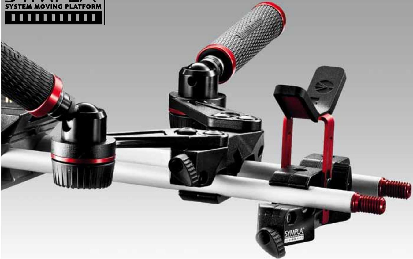
Die vielseitige Universalhalterung ist eine selbsttragende Klemme, die auf den SYMPLA Röhren gleitet und mit einem einzigen Hebel arretiert werden kann. Die Universalhalterung ist ein elementarer Grundbaustein für zahlreiche SYMPLA Komponenten. Über 3/8" Standard-Gewinde kann auch externes Zubehör angeschlossen werden.
