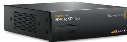
Konvertiert von HDMI nach 12G-SDI. Funktioniert mit allen Videoformaten einschließlich SD, HD, 6G und 12G-SDI und weist einen Up-Konverter zur Umwandlung von HD nach Ultra HD auf. Betten Sie symmetrische Analog- oder AES/EBU-Signale und Timecode-Signale und SDI ein. Ideal um die Signale von HDMI-Consumerkameras nach SDI zu konvertieren oder um mit HDMI-Anschlüssen ausgestattete Computer mit extra SDI-Ausgängen zu versehen.
