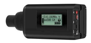
Leistungsstarker Aufstecksender mit Phantomspeisung, erweiterter Bandbreite und Sendeleistung für Systeme der evolution wireless G4 500P-Serie. Für professionelle Filmproduktionen.
