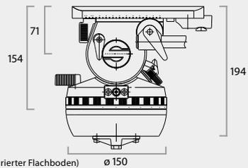
Halbkugel mit Klemmschraube (integrierter Flachboden) ø 150
